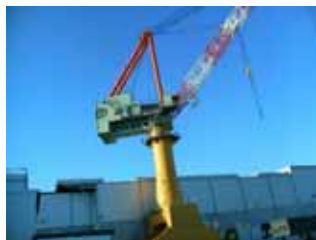
建造船用大型クレーン / 150T吊 (北日本造船久慈工場)
